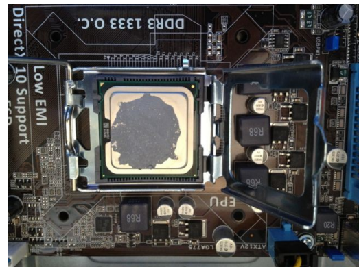
Un microprocesseur et son réceptacle ( socket en anglais)
