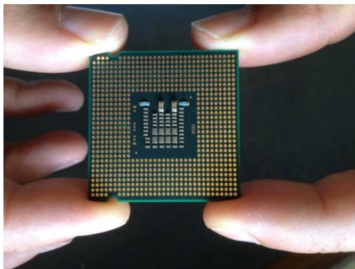
Un microprocesseur et son réceptacle ( socket en anglais)
